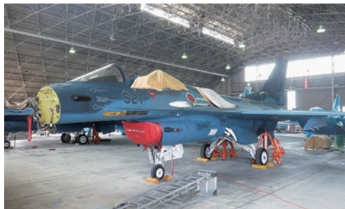
写真1 「共食い」で部品取りのため解体されるF-2戦闘機
